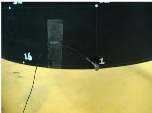
理想加工和安装工艺条件下，圆柱壳各模态应该出现二重频或两个密频，此现象得到实验验证，固有频率成对出现。
